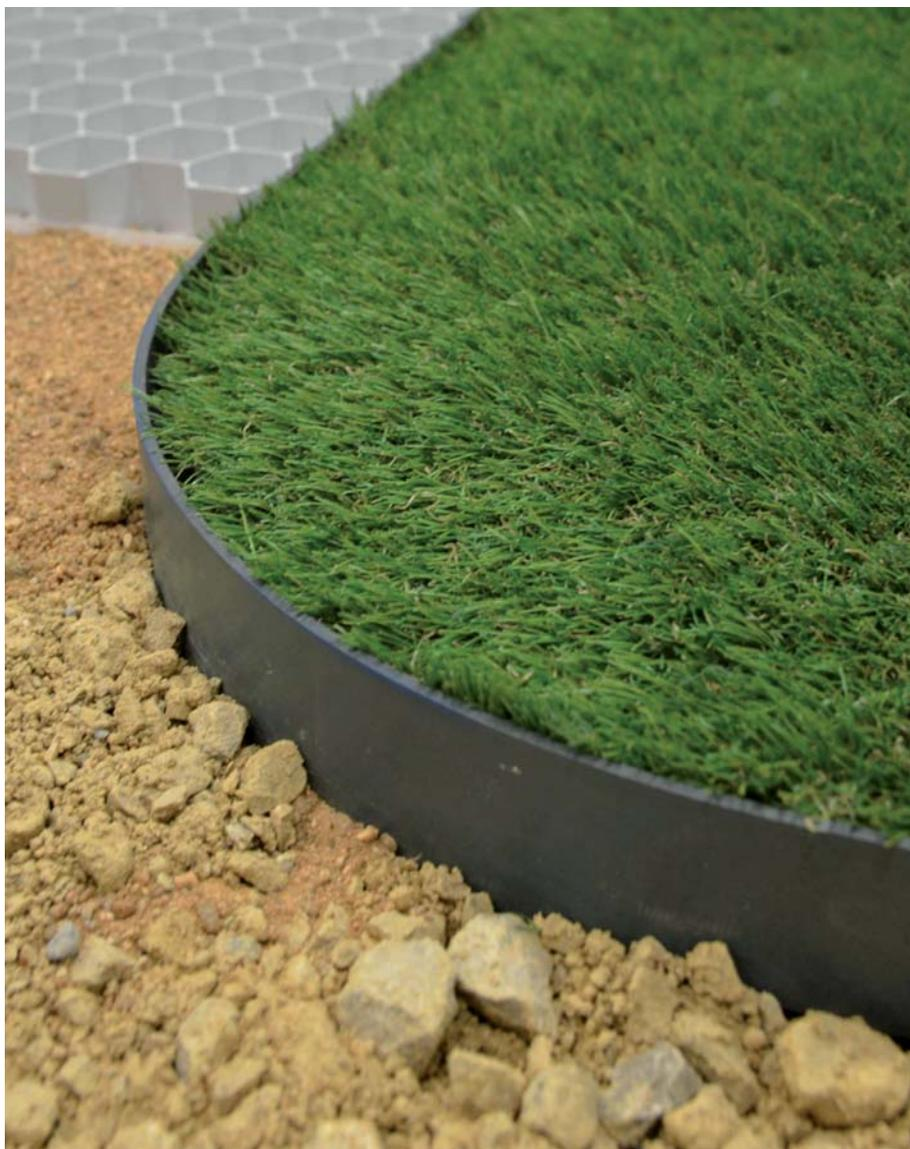
En polyéthylène recyclé, la bordure de délimitation DELIMA® JOUPLAST® permet de délimiter des zones de nature différente (pelouses, massifs, gravier, sable...). Elle stabilise durablement les aménagements extérieurs et crée des surfaces aux lignes droites ou aux courbes harmonieuses. Excellente alternative aux bordures maçonnées, elle se compose de 2 cornières de 1,20 m formant, une fois assemblées, une bordure de 2,40 m, à fixer avec 8 pieux d'ancrage fournis.
